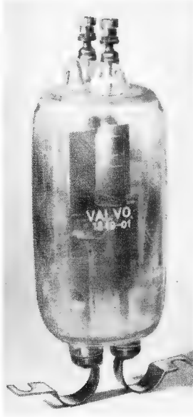
Bild 8. Ignitron PL 5555 mit Wasserkühlung für einen maximalen Anodenstrom (Mittelwert) von 150 bzw. 200 A bei einer maximalen Sperrspannung von \hat{U}_{\max} = 2100 bzw. 900 V. Gesamtlänge 530 mm
