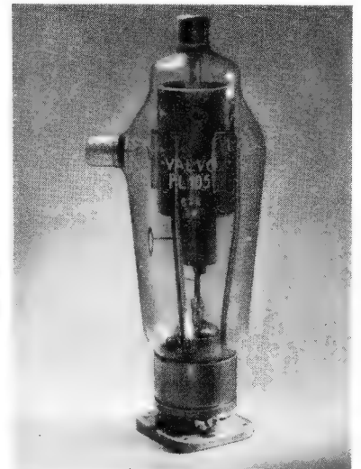
Bild 6. Thyatron oder Stromtor PL 105 für einen maximalen Anodenstrom von I = 6,4 \text{ A} und einen maximalen Scheitelwert der Sperrspannung von \hat{U}_{\text{max}} = 250 \text{ V} . Größte Länge 286 mm
