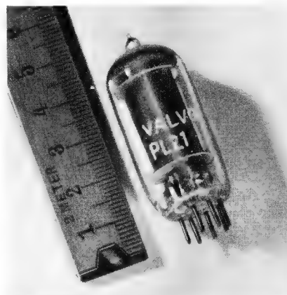
Bild 5. Thyatron 2) oder Stromtor PL 21 für einen maximalen Anodenstrom (Mittelwert) von I = 0,1 \text{ A} und einen maximalen Scheitelwert der Sperrspannung von \hat{U}_{\text{max}} = 500 \text{ V} . Größte Länge 54 mm
